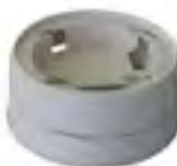
Sirena inserita nella base adatta a ospitare un rivelatore wireless. La sirena via radio con base viene attivata da un comando dalla centrale di gestione; 32 toni selezionabili. Il dispositivo è particolarmente utile in installazioni particolari quali camere d'albergo, uffici, open space ecc. È disponibile un coperchio per l'utilizzo in assenza del rivelatore. Elevata affidabilità funzionale. Di facile installazione, doppia batteria controllata.
